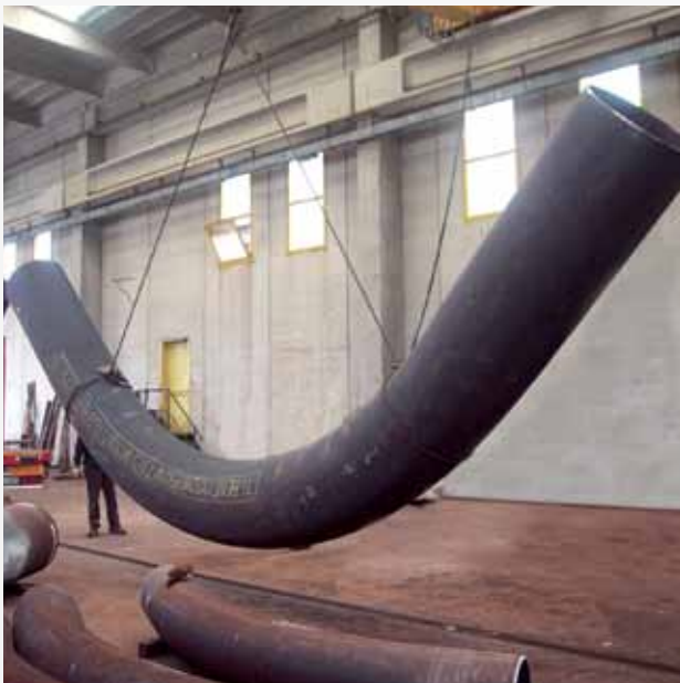
Ống cong bán kính lớn được sản xuất bởi OMP - Mongiardino - Bộ phận Uốn của Tectubi Raccordi
