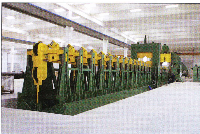
Fase di montaggio della mandrel and banding machine MTC 800
